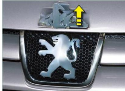
**Pelo exterior:** levantar o comando, levantar o capô e fixá-lo com o equilibrador para mantê-lo aberto.
