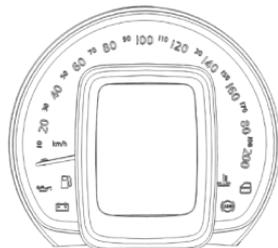
As quilômetros parciais e total, podem ser visualizadas no display. A quilometragem parcial é visualizada no display LCD, atuando na extremidade da alavanca direita, pressionando brevemente o botão **TRIP**.
