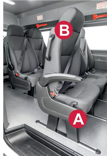
O primeiro assento da 1ª fileira permite uma inclinação de 18° para a frente através da alavanca **A** para aumentar o vão de passagem para a 2ª e 3ª fileiras de assentos. Utilize a alça **B** para auxiliar a inclinação do encosto para a frente.
