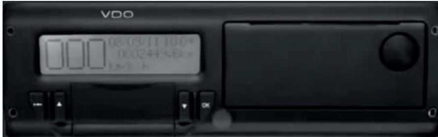
O tacógrafo digital, localizado no painel central, permite cumprir as normas que regulamentam o trabalho do condutor. É responsabilidade do proprietário do veículo, no qual foi instalado o tacógrafo, controlá-lo e aferi-lo regularmente, segundo as leis vigentes.
