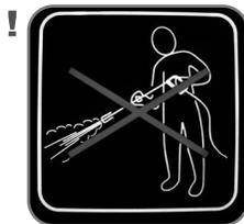
Para não danificar os componentes elétricos do veículo, é expressamente **proibido** utilizar a lavagem a alta pressão no compartimento do motor.
