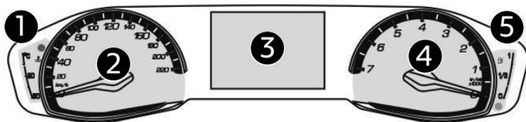
1. Indicador de temperatura do líquido de refrigeração (°C).
