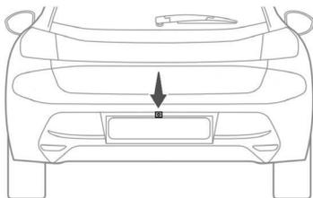
Uma câmera traseira é ativada automaticamente ao engrenar a marcha a ré. A imagem colorida é mostrada na tela de navegação.
