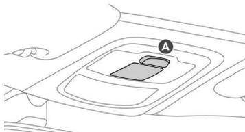
Desencaixe a tampa da luz de teto dianteira **A** com uma chave de parafusos fina, do lado do comando, para acessar a lâmpada com defeito.
