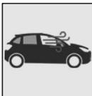
**Vidros** - Conduzir seu veículo com as janelas abertas gera grande interferência na aerodinâmica e no consumo, principalmente em velocidades superiores a 70 km/h.
