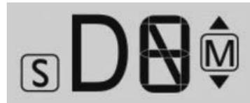
Quando deslocar a alavanca na grelha para selecionar uma posição, acende o respectivo indicador no visor do painel de instrumentos.
