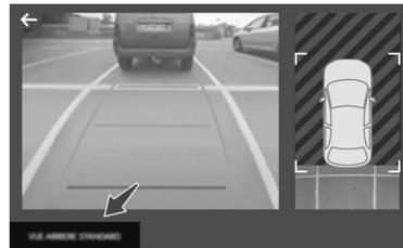
Para ativar a câmara situada na traseira do veículo, engrene a marcha a ré e não ultrapasse a velocidade de 10 km/h.
