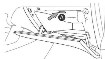
Desencaixe a tampa da luz do porta luvas, com uma chave de parafusos fina, no ponto **A**, para acessar a lâmpada com defeito.
