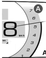
! Ao aproximar-se do limite máximo de rotações **A**, o sistema de injeção eletrônica corta o fluxo de combustível para proteção do motor. Este corte de combustível ocasiona perda de potência do motor.
