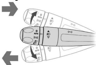
Empurre totalmente para baixo o comando de iluminação para uma manobra para a esquerda. Empurre totalmente para cima o comando de iluminação para uma manobra para a direita.
