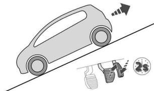
**Em descidas, com o veículo imobilizado e marcha a ré engrenada, este é mantido durante um curto período de tempo, durante a liberação do pedal de freio.**
