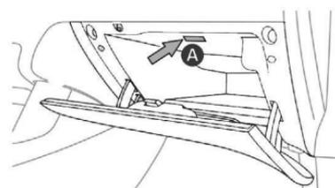
Desencaixe a tampa da luz do porta luvas, com uma chave de parafusos fina, no ponto **A**, para acessar a lâmpada com defeito.
