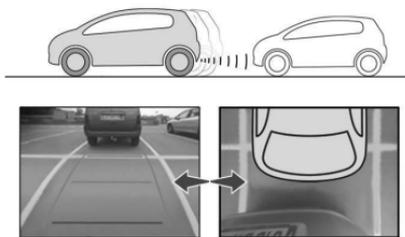
Este modo está ativado por padrão. Com a ajuda dos sensores do para-choque traseiro, a vista automática passa da vista traseira (padrão) para a vista a partir do topo (zoom) quando um obstáculo se aproxima ao nível da linha vermelha (menos de 30 cm) durante a manobra.
