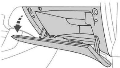
Permite acomodar uma garrafa de água, a documentação de bordo do veículo etc. Para abrir o porta-luvas, levante o puxador e acompanhe a tampa até à sua posição aberta. Com a ignição ligada, o porta-luvas se ilumina ao abrir a tampa.
