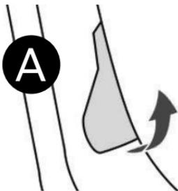
**i** A implantação do comando interior impede qualquer abertura, enquanto a porta esquerda dianteira se encontrar fechada.
