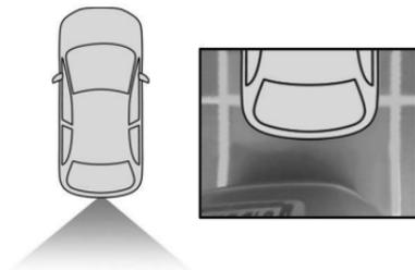
A câmara regista a área ao redor do veículo durante a manobra para reconstituir uma imagem a partir da parte traseira do veículo no ambiente em que se encontra, permitindo realizar a manobra do veículo
