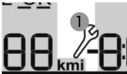
O indicador de manutenção **1** é apresentado durante alguns segundos ao ligar a ignição. Informa o motorista sobre o prazo para a próxima revisão a efetuar, de acordo com o plano de manutenção do construtor.
