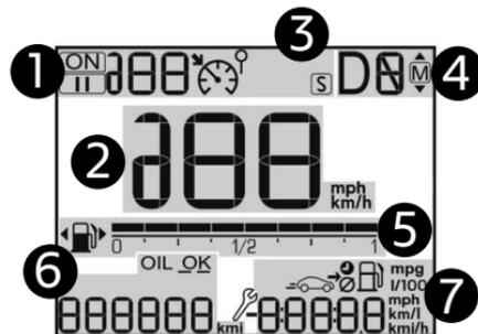
1. Definições do regulador de velocidade/limitador de velocidade.
