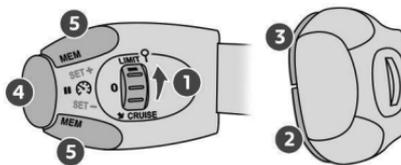
Gire o botão **1** para a posição "LIMIT": para seleccionar o modo limitador; a função é colocada em pausa.
