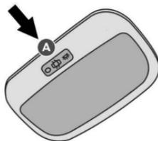
Desencaixe a tampa da luz de teto traseira com uma chave de parafusos fina no ponto **A**, para acessar a lâmpada com defeito.
