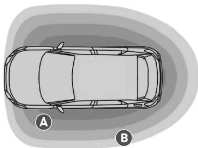
**Zona A:** destravamento automático e iluminação de boas-vindas quando se aproxima do veículo (entre 1 e 2 metros do veículo).
