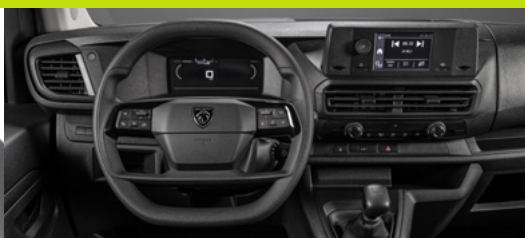
Novo volante com comandos, painel de instrumentos digital e tela touch de 5"
